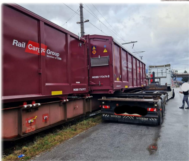
Verladung des Mobiler-Container auf die Bahn
