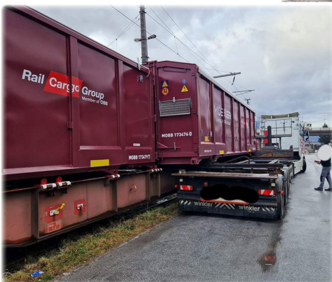
Verladung des Mobiler-Container auf die Bahn
